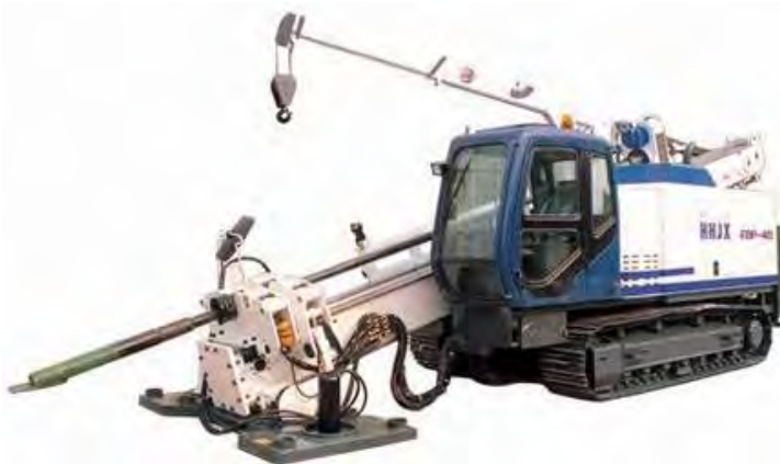
Рисунок 1.1 – Установка горизонтально-направленного бурения
