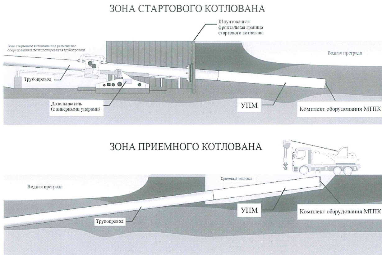
Рисунок 8.7 – Общая схема производства работ по технологии ГНБЦ
